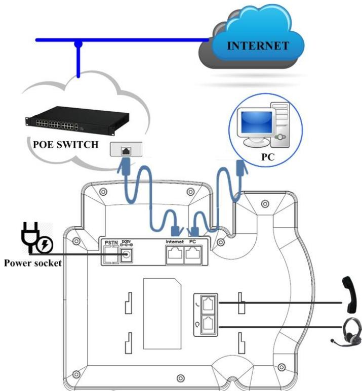
IP-телефон Akuvox имеет встроенный 2-х портовый коммутатор (а также, может работать в режиме маршрутизатора) для подключения через него ПК и другой периферии без потери свободного Ethernet порта на головном коммутаторе учреждения или доступной вам Ethernet розетки.
